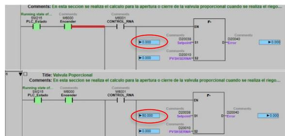
Figura 7. Cambio de parámetros reflejado en el sistema de control.
