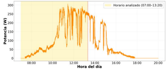
Figura 3. Curva típica de operación para el panel monocristalino.
